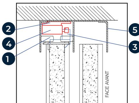
Positionner le frein en butée sur le mur
